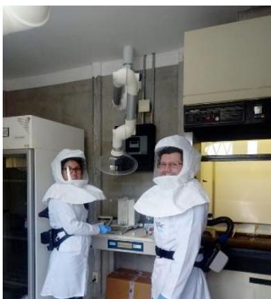
*Ilustración 2 Equipo de seguridad especializado y brazo extractor.*
